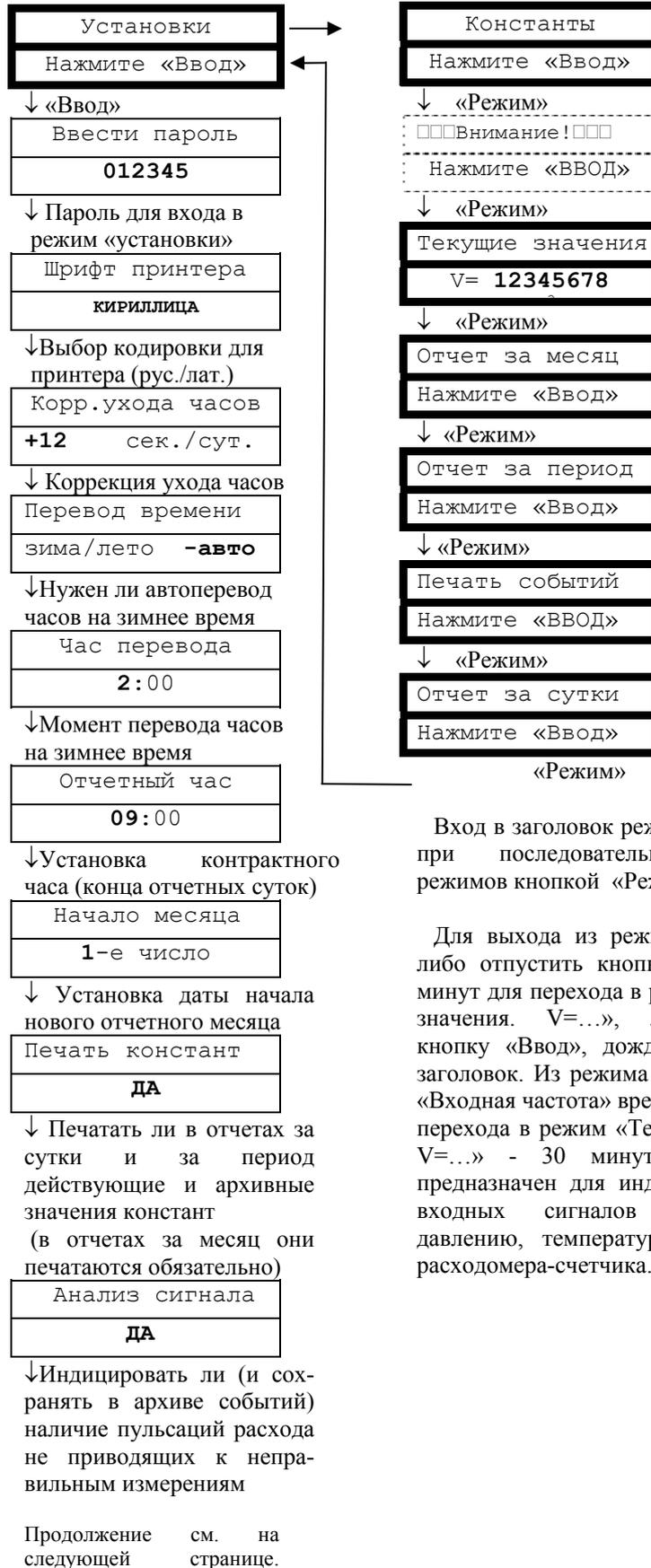
Вход в заголовок режима происходит при последовательном переборе режимов кнопкой «Режим».
