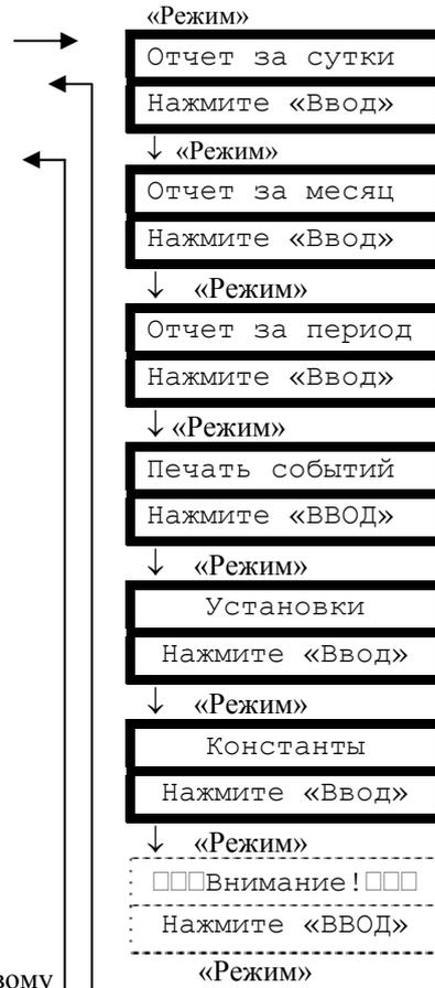
Вход в заголовок режима происходит при последовательном переборе режимов кнопкой «Режим».
