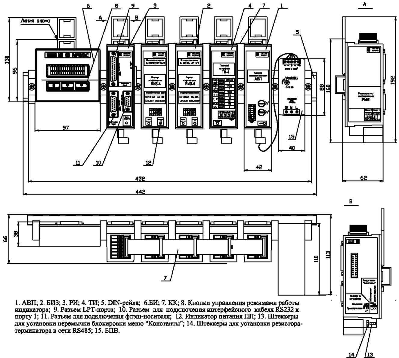
1. АВП; 2. БИЗ; 3. РИ; 4. ТИ; 5. DIN-рейка; 6.БИ; 7. КК; 8. Кнопки управления режимами работы индикатора; 9. Разъем LPT-порта; 10. Разъем для подключения интерфейсного кабеля RS232 к порту 1; 11. Разъем для подключения флэш-носителя; 12. Индикатор питания ППИ; 13. Штекеры для установки перемычки блокировки меню "Константы"; 14. Штекеры для установки резистора-терминатора в сети RS485; 15. БПВ.
