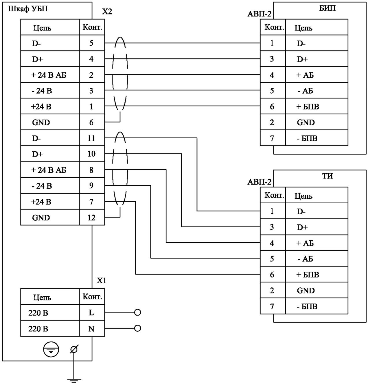
Схема подключения ПЭВМ (IBM PC) к ультразвуковым расходомерам-счетчикам
