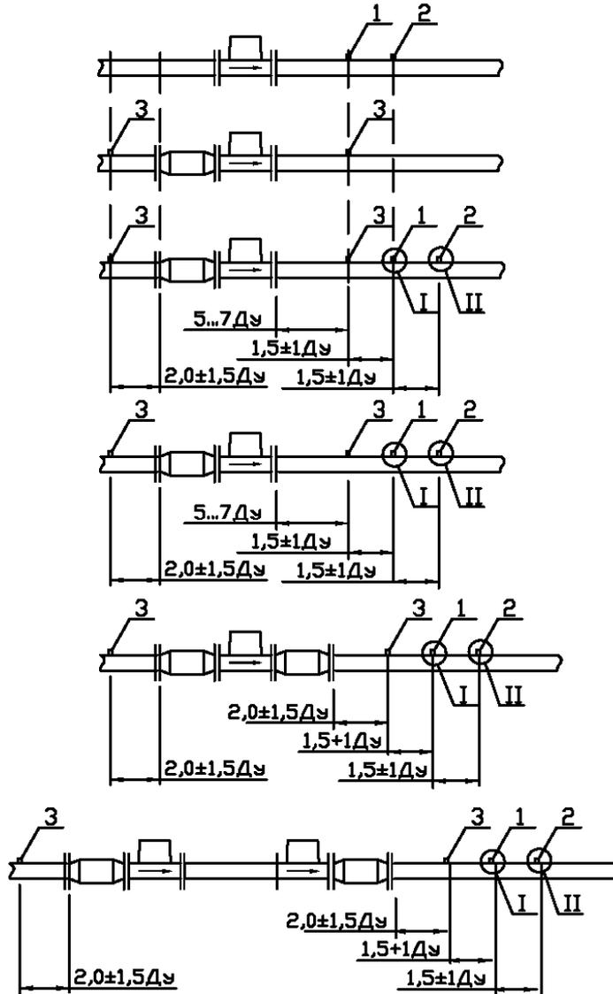
1. Штуцер для контрольного манометра; 2. Штуцер для контрольного термометра; 3. Штуцеры для измерения перепада давления.
