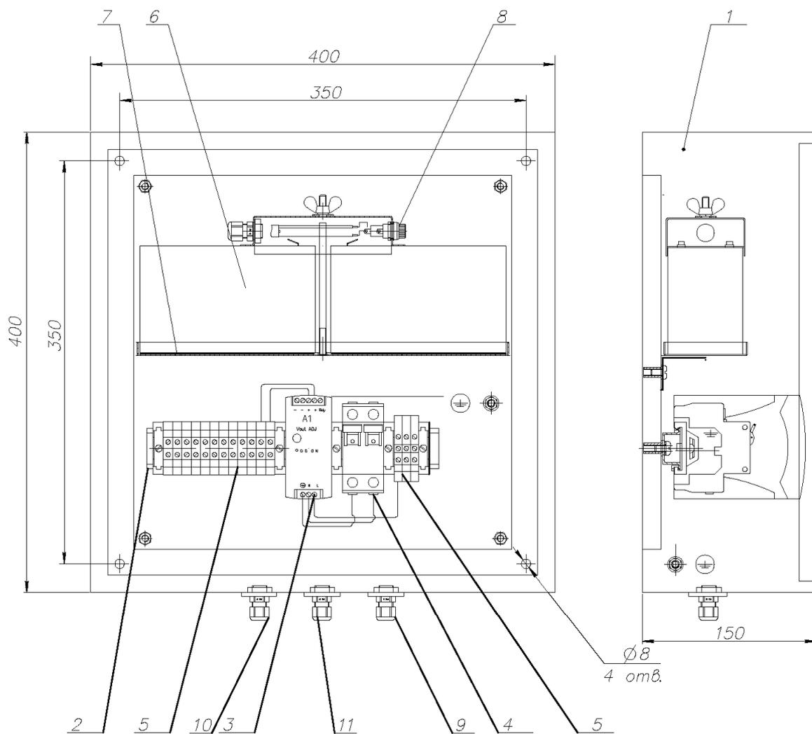
1. Корпус; 2. DIN-рейка; 3. БПВ; 4. Автомат защиты; 5. Клеммные колодки; 6. БАБ; 7. Кронштейн; 8. Плавкий предохранитель; 9. Кабельный ввод сетевого кабеля 220В; 10. Кабельный ввод кабеля для подключения БИП; 11. Кабельный ввод кабеля для подключения блока ТИ (при его наличии).
