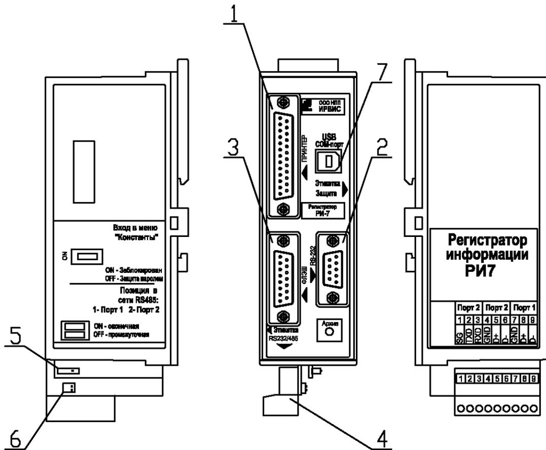
1. Разъем LPT-порта; 2. Разъем RS-232; 3. Разъем для подключения флэш-носителя;
