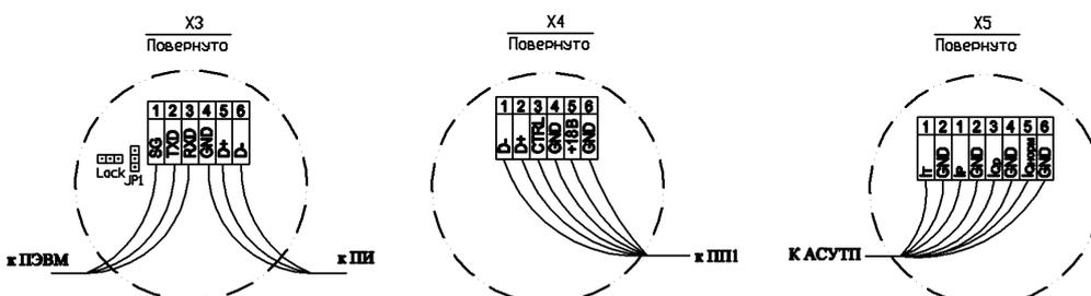
Рисунок 2 – Схемы подключения БИП расходомера-счетчика
