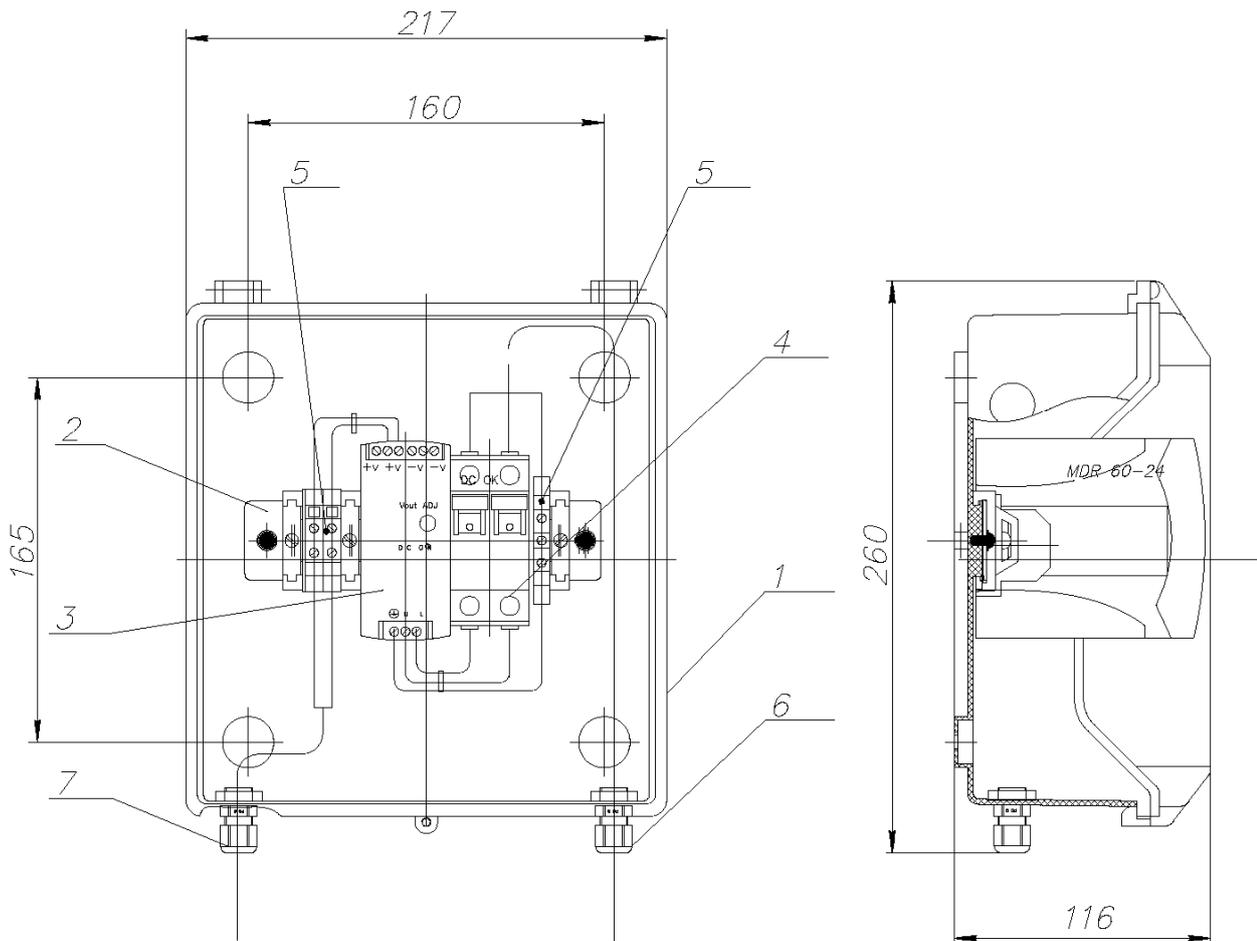
1. Корпус; 2. DIN-рейка; 3. БПВ; 4. Автомат защиты; 5. Клеммные колодки; 6. Кабельный ввод сетевого кабеля 220В 7. Кабельный ввод кабеля питания БИП.
